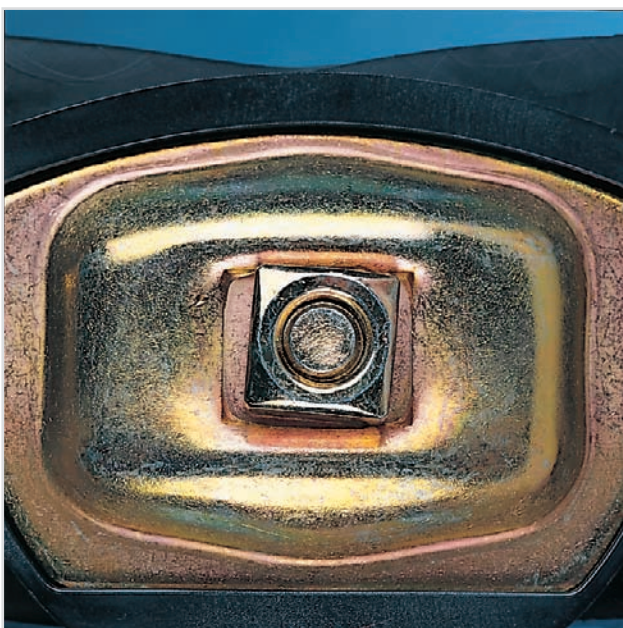
5. Speciale constructie voorkomt meedraaien moer.
